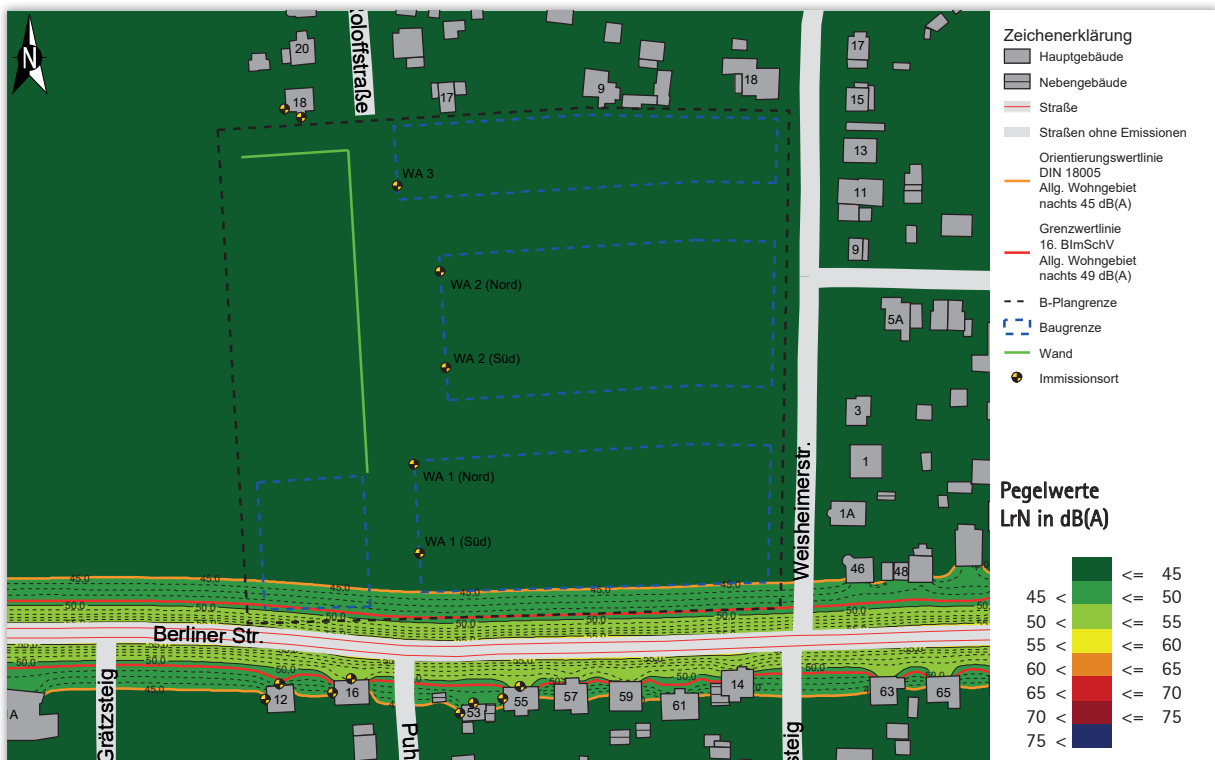
Abbildung 4-5 Rasterlärkarte in 2 m Höhe über Gelände, Beurteilung gemäß DIN 18005, 22:00 - 06:00 Uhr
