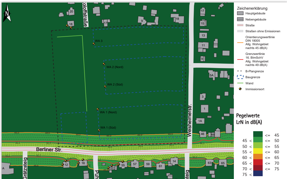
Abbildung 4-7 Rasterlärmkarte in 5 m Höhe über Gelände, Beurteilung gemäß DIN 18005, 22:00 - 06:00 Uhr
