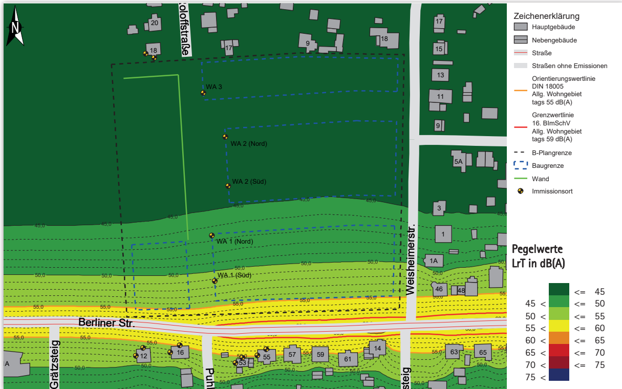
Abbildung 4-8 Rasterlärkarte in 8 m Höhe über Gelände, Beurteilung gemäß DIN 18005, 06:00 - 22:00 Uhr
