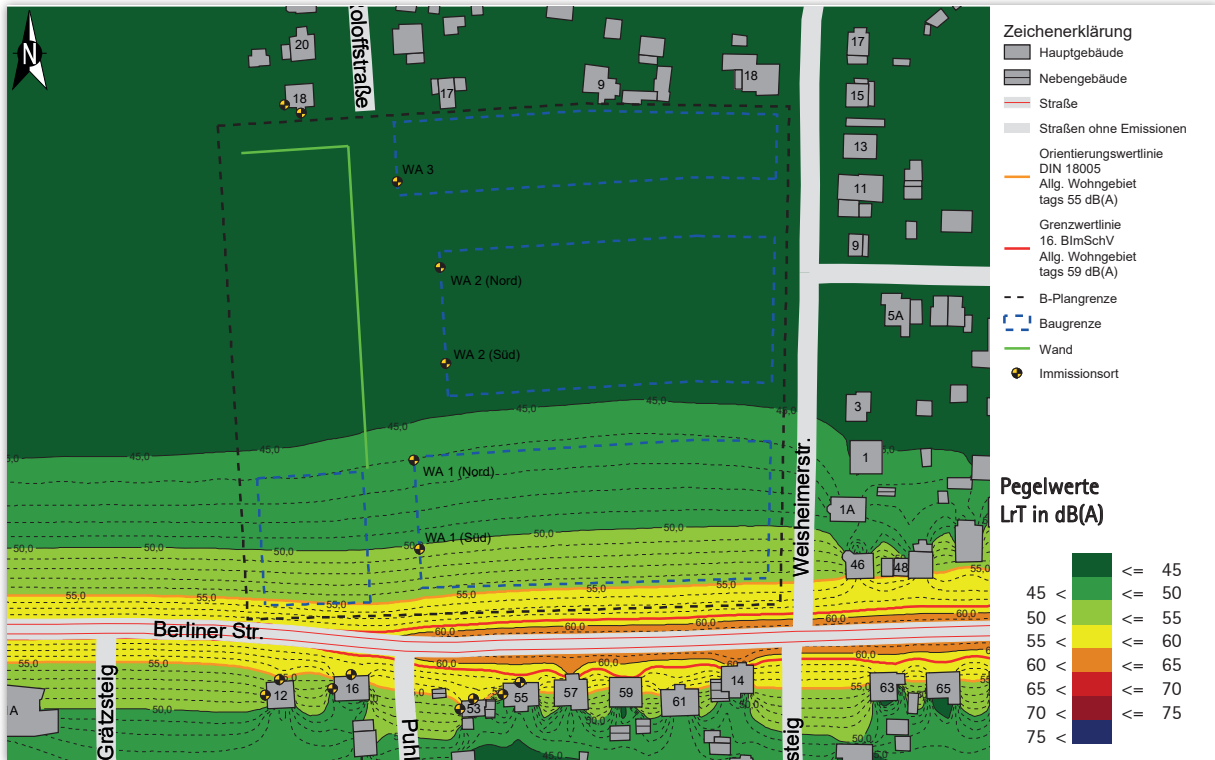
Abbildung 4-6 Rasterlärmkarte in 5 m Höhe über Gelände, Beurteilung gemäß DIN 18005, 06:00 - 22:00 Uhr
