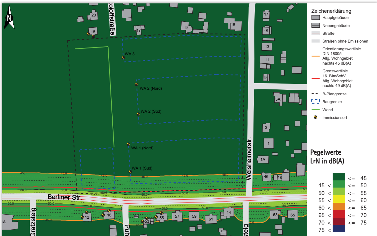
Abbildung 4-9 Rasterlärkarte in 8 m Höhe über Gelände, Beurteilung gemäß DIN 18005, 22:00 - 06:00 Uhr
