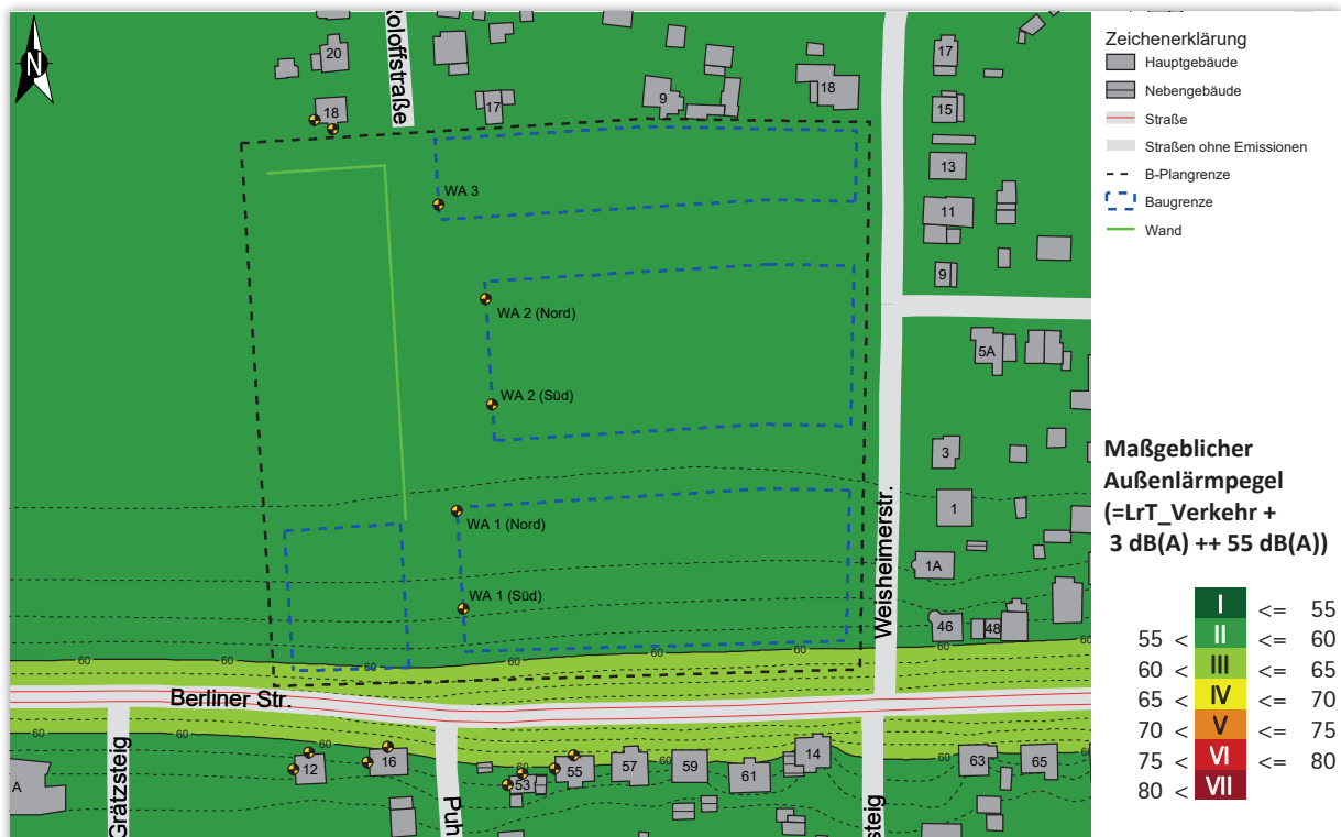
Abbildung 4-10 Maßgeblicher Außenlärmpegel sowie die Lärmpegelbereiche
